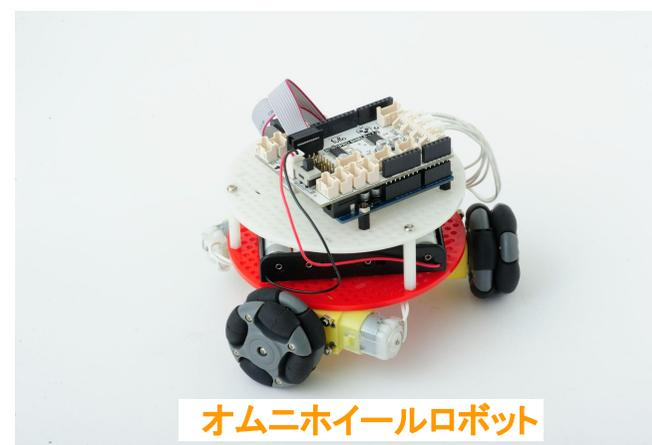
3輪駆動で自由に移動するロボットを製作し、動かしながら、「力の合成」「力のモーメント」を学びます
