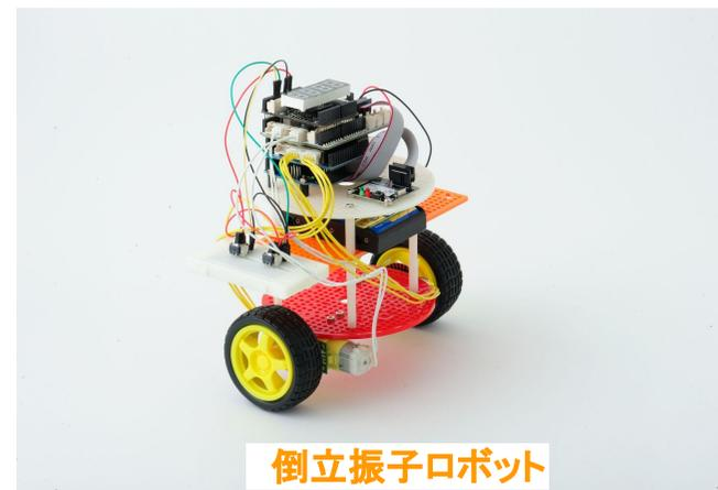
自身の姿勢を検知し、倒れないようにタイヤを回転させる逆振り子型ロボットです。「PID制御」という実際のロボット・産業機械にも使われる制御方法を学びます。
