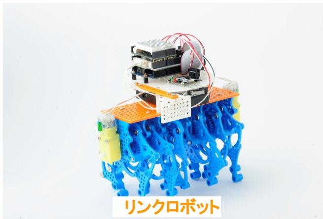
リンク機構を用いた多脚歩行ロボットを製作し、「リンク機構の知識」「ロボットの移動原理」を学びます。
